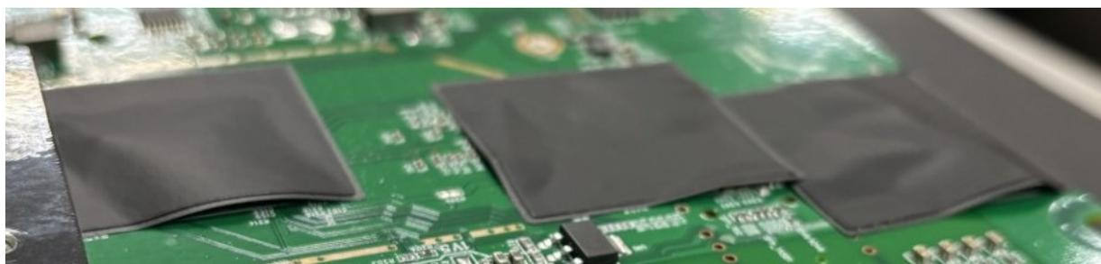
二、於 PCB Bottom 安裝散熱片及鎖上螺絲
