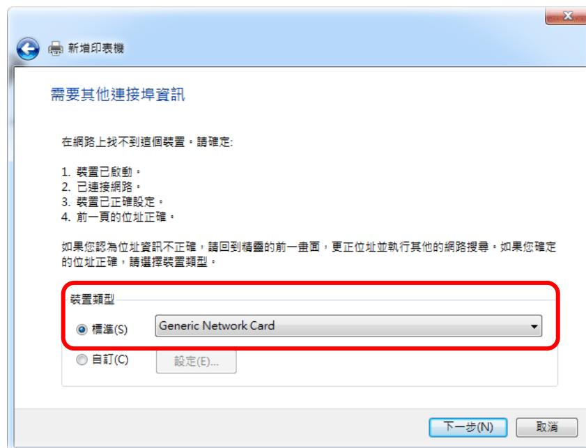
8. 現在系統將會要求您選擇您安裝至路由器上的印表機名稱，這個步驟可以讓您的電腦安裝正確的驅動程式，當您完成項目選擇之後，請按下一步。
