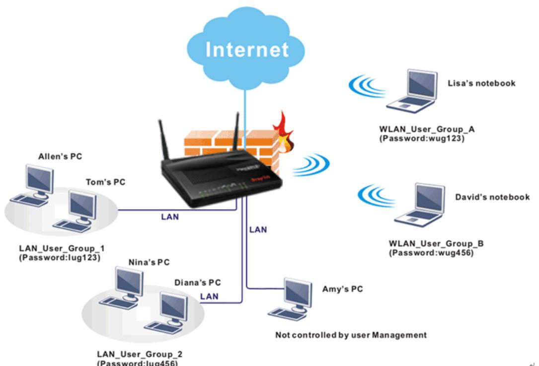
**注意：**防火牆中過濾器規則通常只會套用再主機上(亦即路由器安裝的那台)，有了使用者管理功能之後，設定的規則就可以套用在連結上該台路由器的每一個使用者電腦上。
