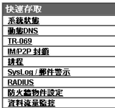
本區將系統狀態(System Status)、動態 DNS (Dynamic DNC)、TR-069、IM/P2P 封鎖(IM/P2P Block)、排程(Schedule)、Syslog/郵件警示(Syslog/Mail Alert)、RADIUS、防火牆物件設定(Firewall Object Setting)以及資料流量監控(Data Flow Monitor)等常用連結歸納於此，移動您的滑鼠至任何一個連結在輕輕按下，相應頁面即可立刻開啟。
